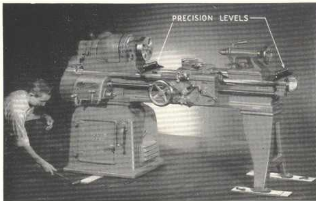
Fig. 23. Leveling the Lathe
