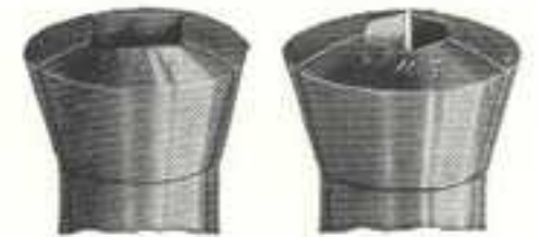
Fig. 164. Square Collet Fig. 165. Hexagon Collet
